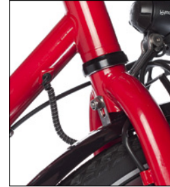
Verstärkter Kabel-Eintritt: Der Stahlrahmen des Böttcher Evolution wurde auf Robustheit optimiert.
